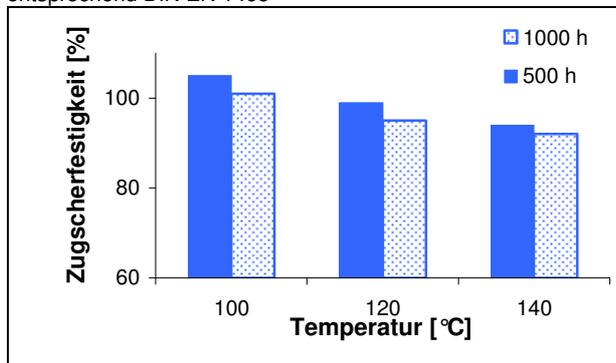
Zugscherfestigkeit Al/Al bei Temperatur bezogen auf Wert bei Raumtemperatur gemessen bei angegebener Temperatur entsprechend DIN EN 1465
